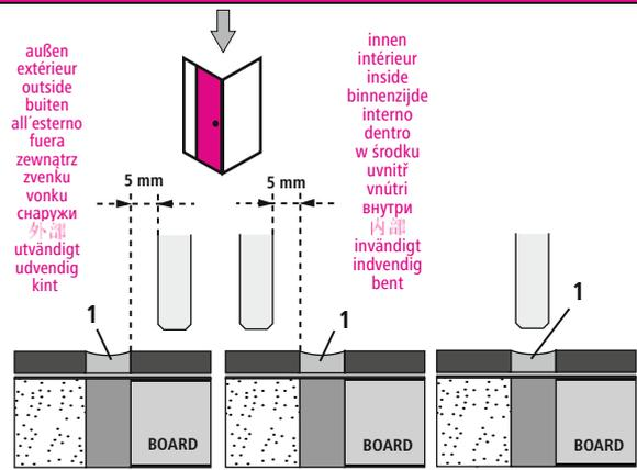
**2** **Versiegelung** / Scellement / Sealing / Siliconen-kitnaad / Sigillatura / Sellado / Uszczelnienie zewnętrzne / Uzavírací nátěr / Tesniaca hmota / Герметик / 密封胶 / Føsegling / Forsegling / Etzárás
