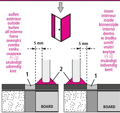
**1** **Wartungsfuge** / Joint de maintenance / Maintenance joint / Voegnaad / Fughe di manutenzione / Junta de mantenimiento / Spoina wymagająca konserwacji / Spára pro údržbu / Servisná medzera / Технологический шов / 维护缝 / Underhållsfog / Vedligeholdelsesfuge / szilikon fuga
